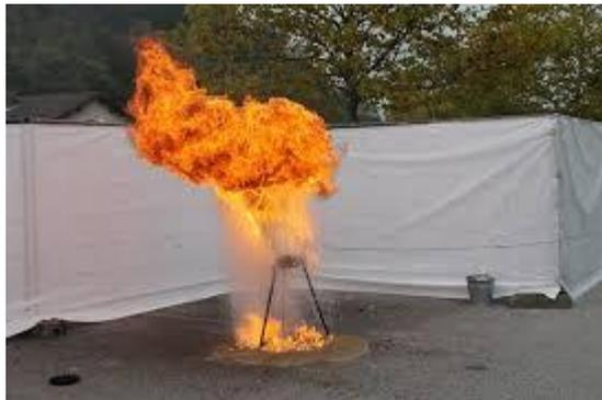
**Illustration de la réaction d'un feu de friteuse aspergé d'eau**
